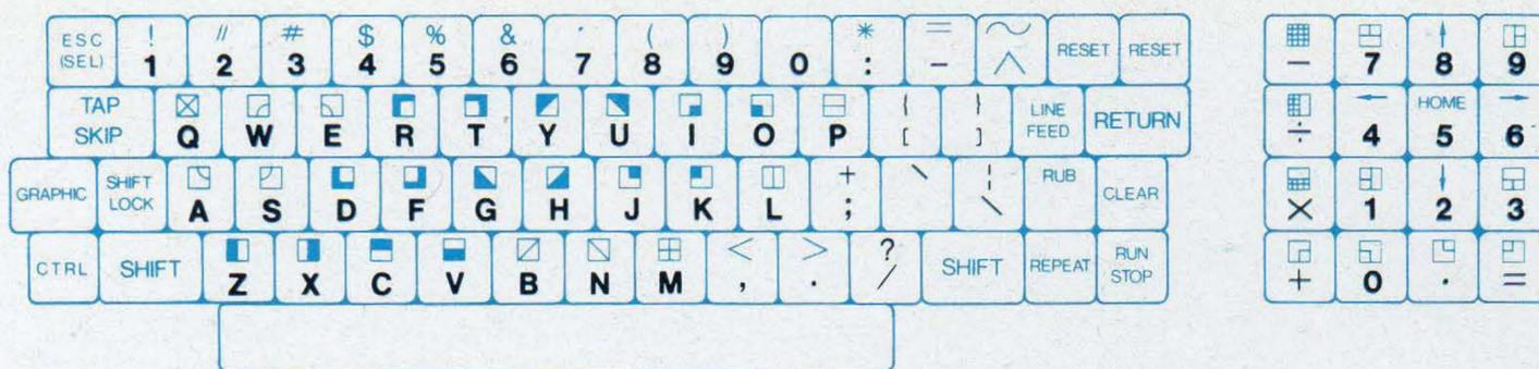
Figura 3 — Il Sorcerer ha una tastiera professionale, del tipo di una macchina per scrivere, completa per la gestione delle informazioni, con una sezione di 16 tasti numerici e aritmetici (tipo calcolatrice) per velocizzare l'ingresso dei dati e le interrogazioni. La tastiera consiste di 79 tasti alfanumerici, con maiuscole e minuscole e caratteri grafici. Esistono tasti di «editing» e di controllo. È possibile assegnare qualsiasi simbolo o carattere speciale a qualsiasi tasto.
